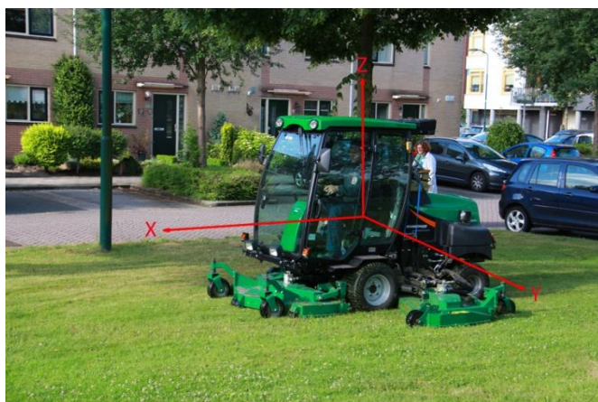
Figuur 2: Visuele illustratie van de trillingsrichtingen X, Y en Z.
