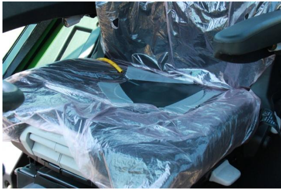
Figuur 3: Illustratie bij de meting van lichaamstrillingen op de stoel van de maaimachine: de opnemer voor trillingen is op de stoelzitting vastgezet met bouwtape.
