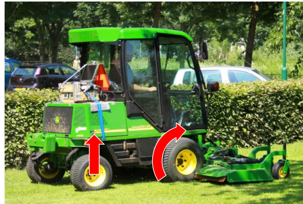
Figuur 13: Illustratie ter verklaring van het mogelijk ontstaan van boekeversnellingen rond de vooras door verticale versnellingen van de achterwielen.
