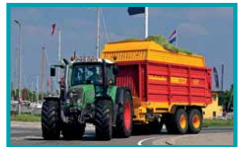
Deze aanhangwagen met een gewicht van meer dan 3500 kg moet voorzien zijn van een goed werkende reminrichting.
