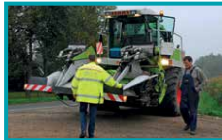
Uitstekende delen die gevaarlijk zijn voor andere weggebruikers, moeten zijn afgeschermd.
