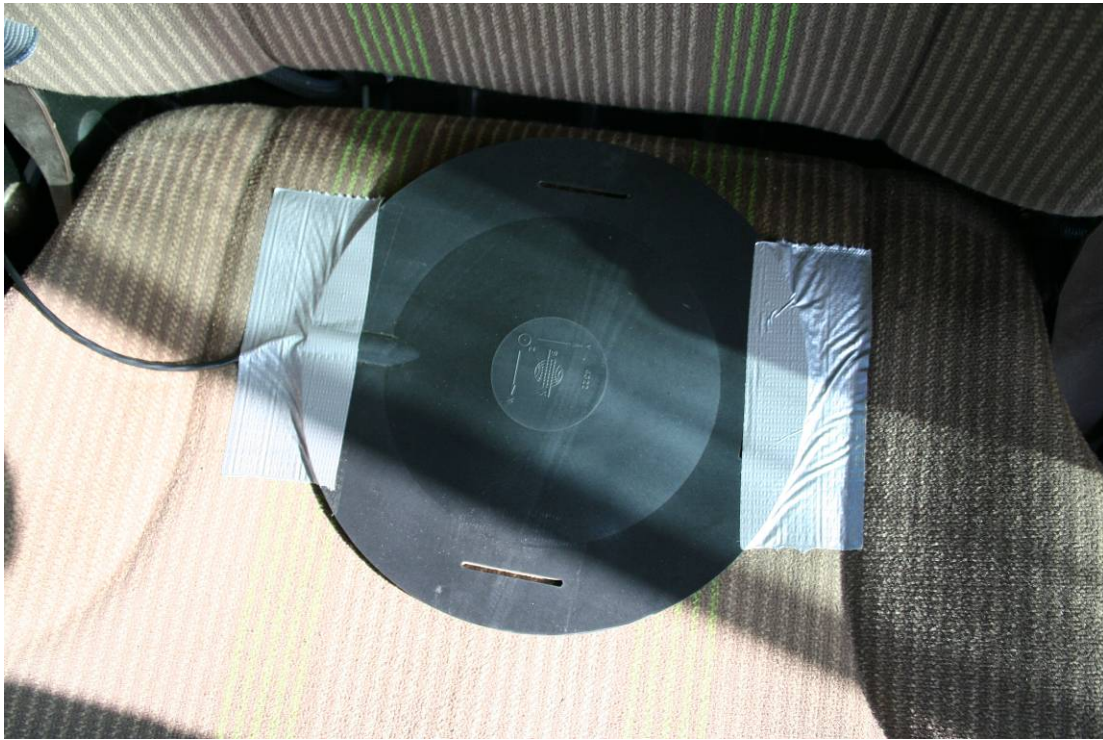
Figuur 1: illustratie bij de meting van trillingen tijdens trekkerwerk: montage van de opnemer voor trillingen op de stoelzitting.
