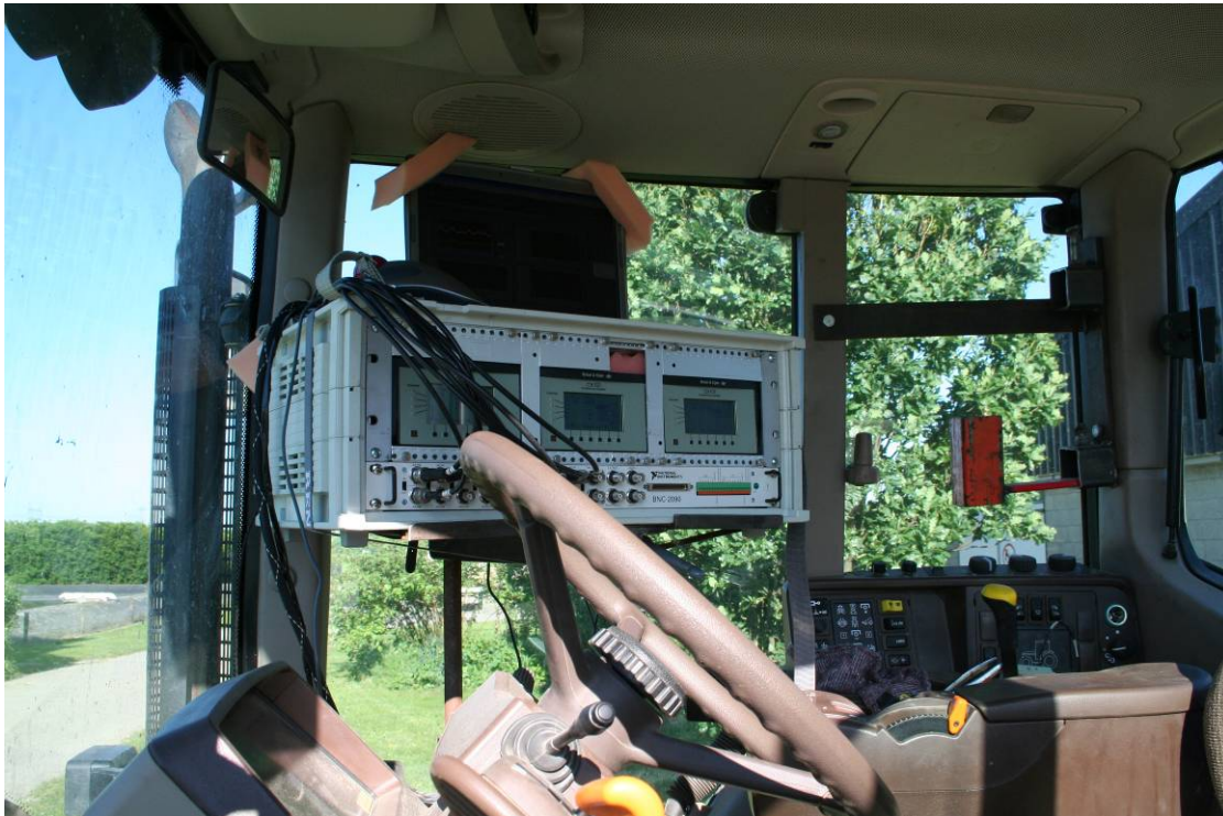
Figuur 3: illustratie bij de meting van trillingen tijdens trekkerwerk: montage van de meetapparatuur in de cabine.
