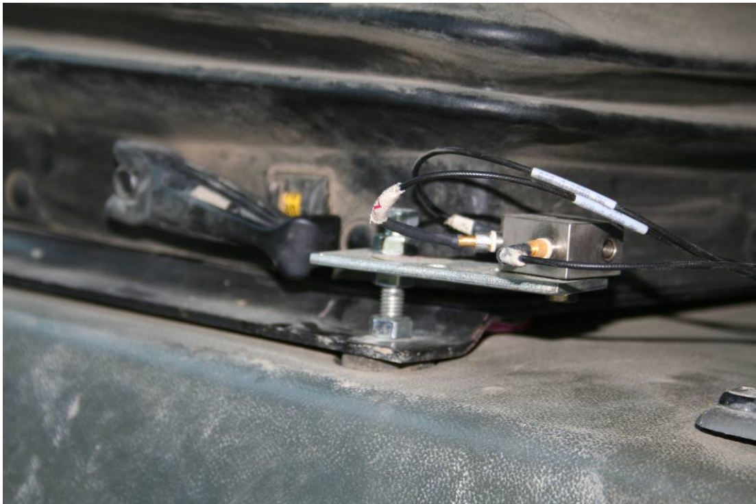
Figuur 2: illustratie bij de meting van trillingen tijdens trekkerwerk: montage van de opnemer voor trillingen aan de stoelbasis.
