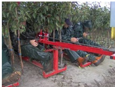
Foto's: Advies bij langdurig kruipen of knielen: mechaniseer of gebruik zit(hulp)middelen om knielen te voorkomen, bijv. gewasstoeltje of portaaltrekker met zitjes
