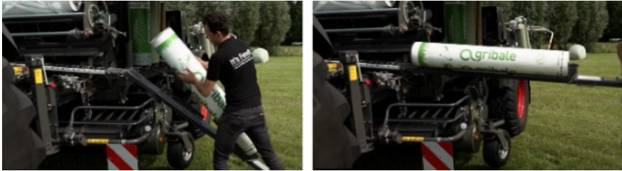
Afbeelding: Tilhulp van Fendt om folierollen in te voeren
