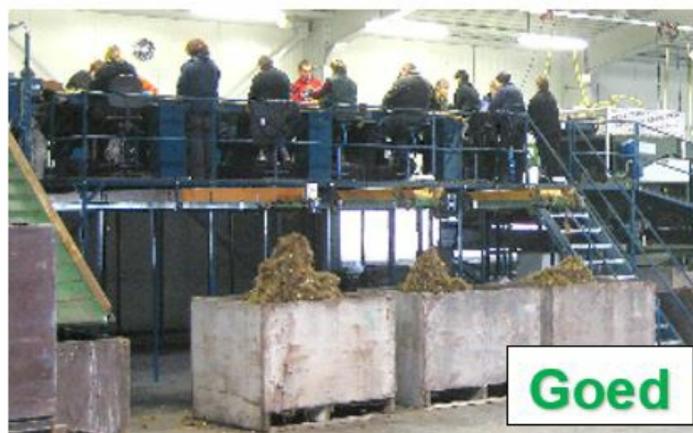
Afbeelding: Bij 1e foto sprake van valgevaar door klein werkplateau, los trappetje en ontbreken van afscherming (fout) en bij de 2e foto gangbare, juiste afscherming van werkplateau (goed)
