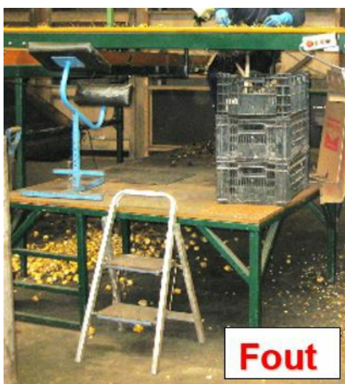
Afbeelding: Bij 1e foto sprake van valgevaar door klein werkplateau, los trappetje en ontbreken van afscherming (fout) en bij de 2e foto gangbare, juiste afscherming van werkplateau (goed)
