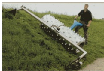
Foto: Tweewielige trekker met speciale noppen voor taluds
