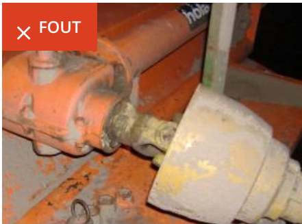
Kap werktuigzijde ontbreekt
