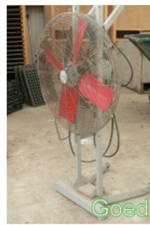
Goed afgeschermd ventilator
