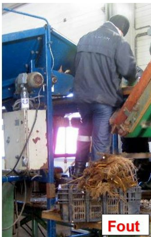
Afbeelding: Bij 1e foto sprake van valgevaar door klein werkplateau, los trappetje en ontbreken van afscherming (fout) en bij de 2e foto gangbare, juiste afscherming van werkplateau (goed)
